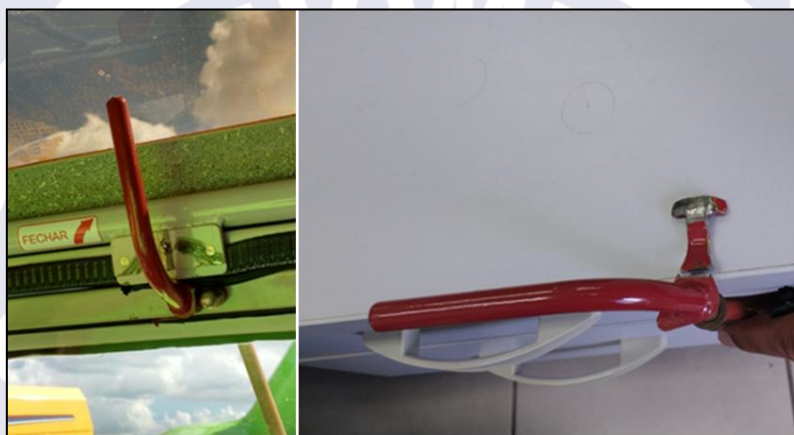
Figura 3 - Maçaneta e trava da porta direita quebrada.
