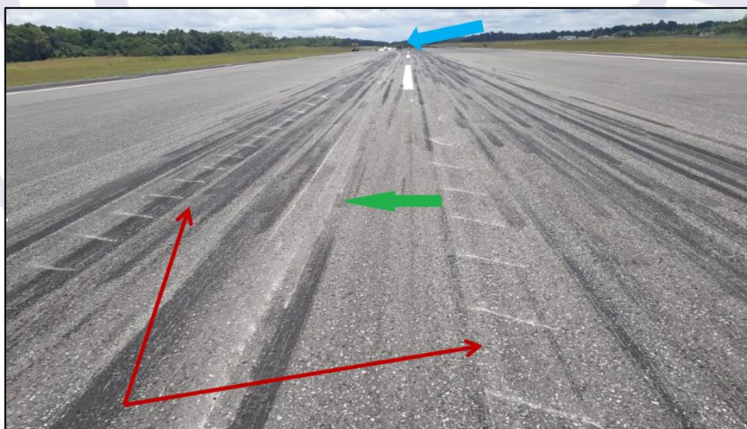
Figura 4 - Marcas deixadas pela aeronave na pista. Local da parada total (seta azul). Marcas deixadas pelas hélices (setas vermelhas). Marcas deixadas pela fuselagem (seta verde).
