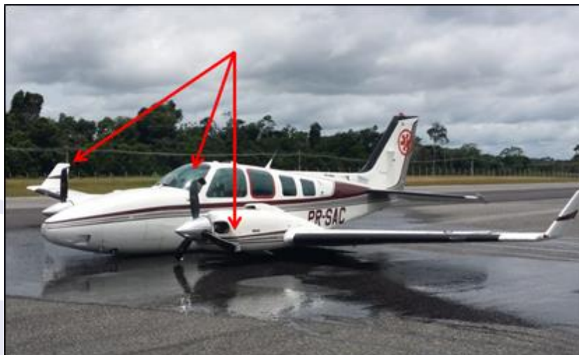
Figura 3 - As setas vermelhas indicam as deformações das hélices devido ao contato com o solo.
