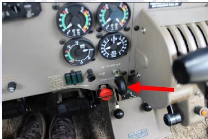
Figura 3 - Comando do trem de pouso do PR-ACR.
