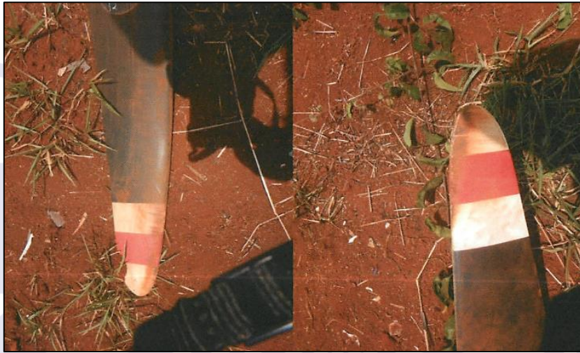
Figura 5 - Vista das pás mostrando riscos transversais.
