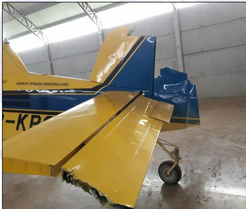
Figura 3 - Danos ao estabilizador vertical, leme e profundor.
