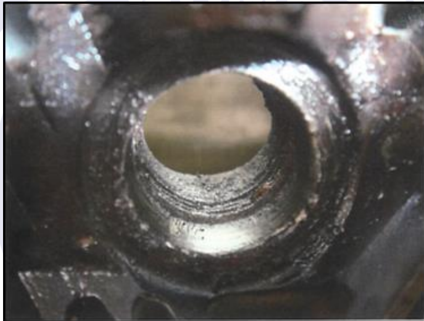
Figura 5 - Vista do cilindro com a rosca fêmea desgastada.
