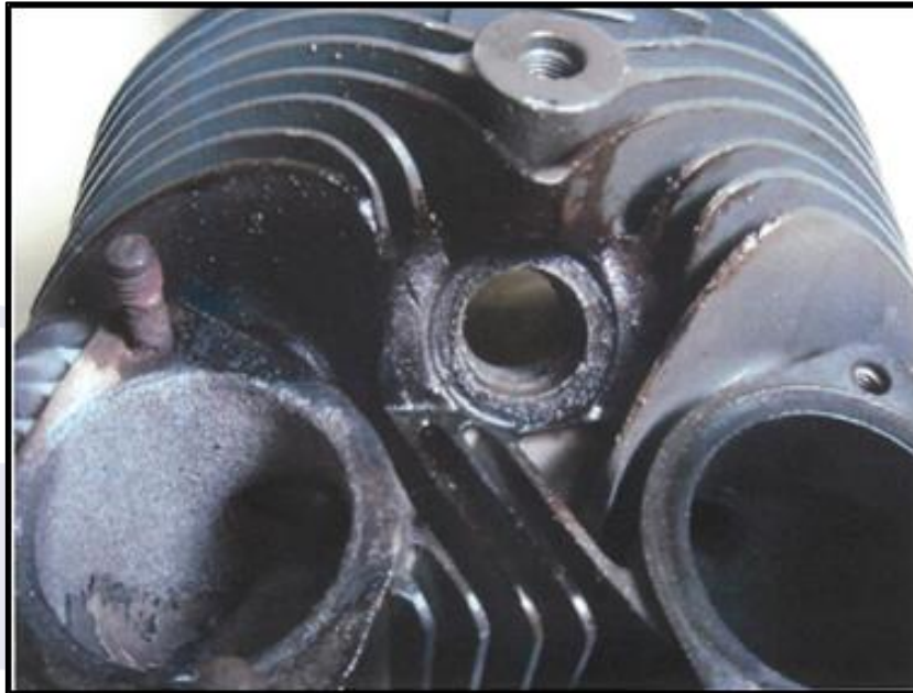
Figura 4 - Vista geral da rosca fêmea do cilindro PN-LW11633.
