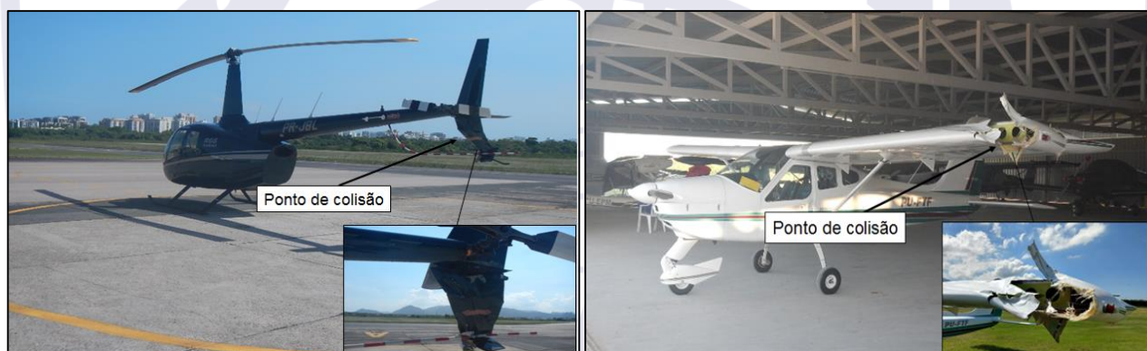
Figura 1 - Detalhe dos danos em ambas as aeronaves.
