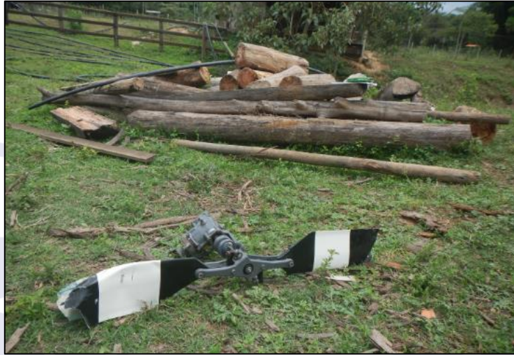
Figura 2 - Vista da posição de parada do rotor de cauda, após seu desprendimento do cone de cauda.
