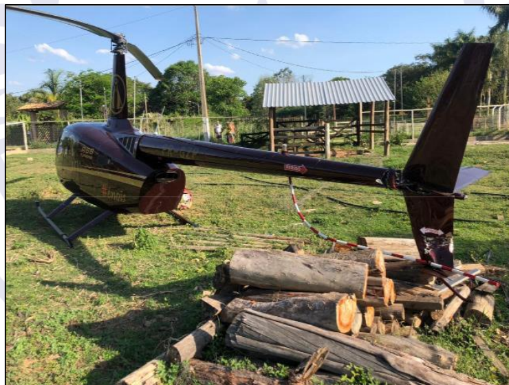
Figura 1 - Vista do ponto de colisão do rotor de cauda com a pilha de madeiras.
