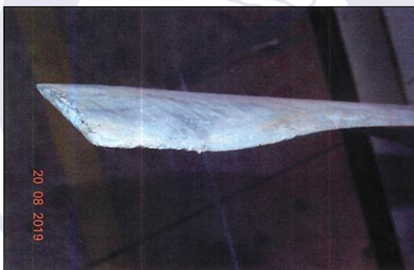
Figura 3 - Vista da extremidade da pá com dobramento, riscos e massa.
