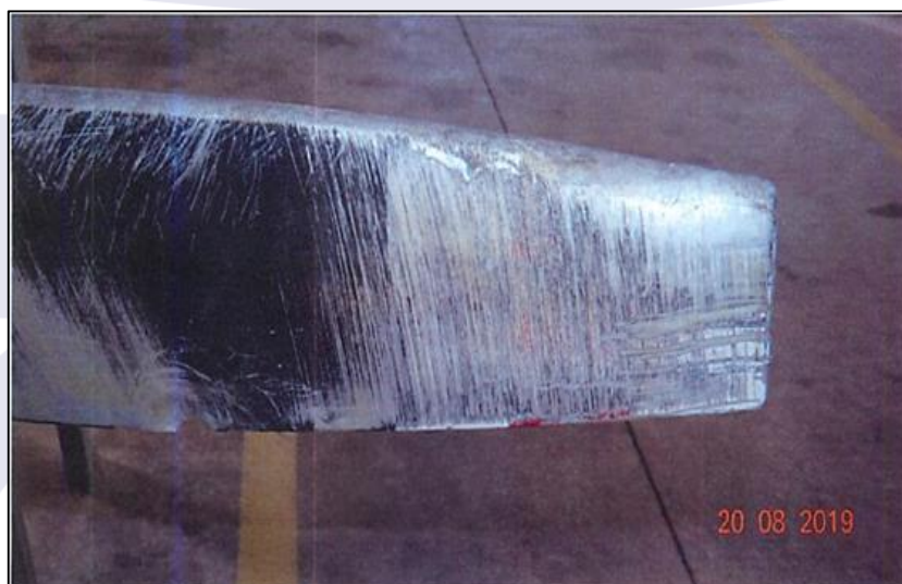
Figura 2 - Vista da extremidade da pá com riscos transversais e massa.
