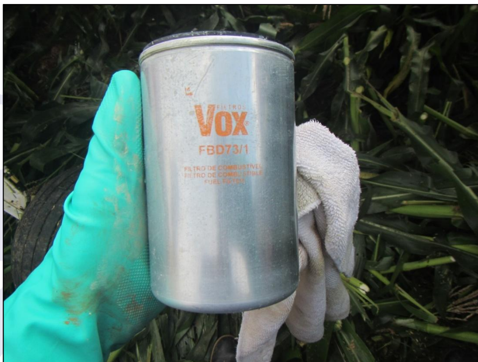
Figura 3 - Filtro de combustível instalado na aeronave.
