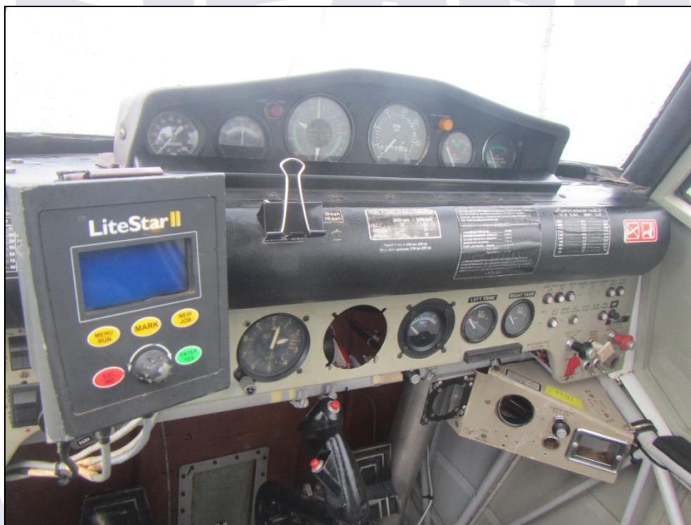
Figura 2 - Painel da aeronave sem as marcas e placas exigidas para utilização de etanol.
