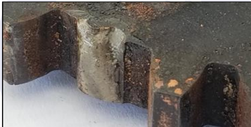
Figura 3 - Marca na Gear Assembly Crankshaft Idler quebrada, indicando que ela quebrou após o incêndio.
