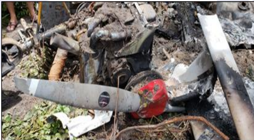
Figura 2 - Motor no local do acidente, encoberto de areia utilizada para apagar o fogo.
