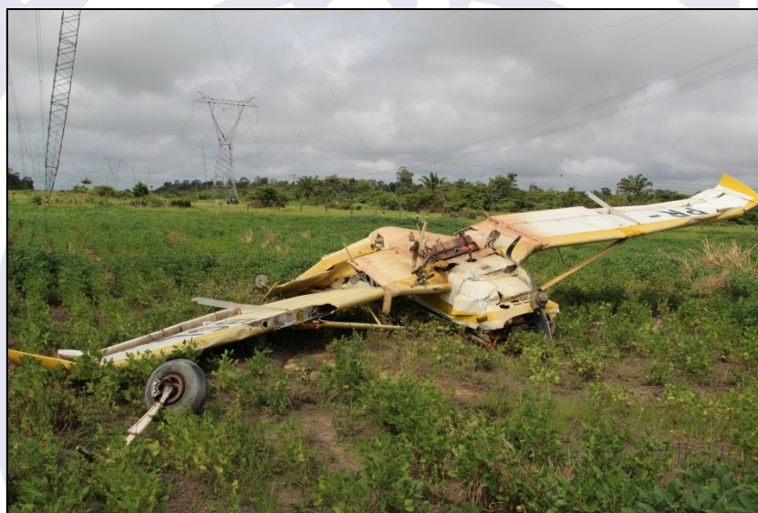
Figura 1 - Aeronave após o impacto com a fiação da rede de alta tensão.
