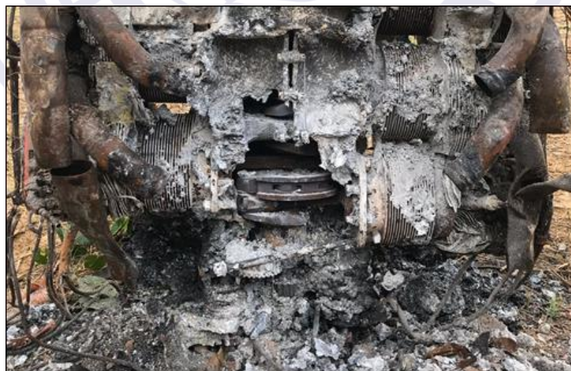
Figura 3 - Vista do motor do PT-BYQ mostrando a severidade dos danos decorrentes do fogo.
