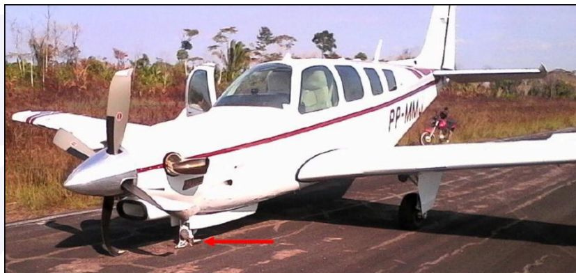
Figura 3 - Vista frontal esquerda da aeronave. A seta vermelha identifica o local de quebra do trem de pouso auxiliar.
