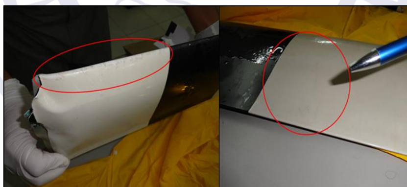
Figura 5 - Marcas de impacto da ave contra o bordo de ataque da pá do rotor de cauda.
