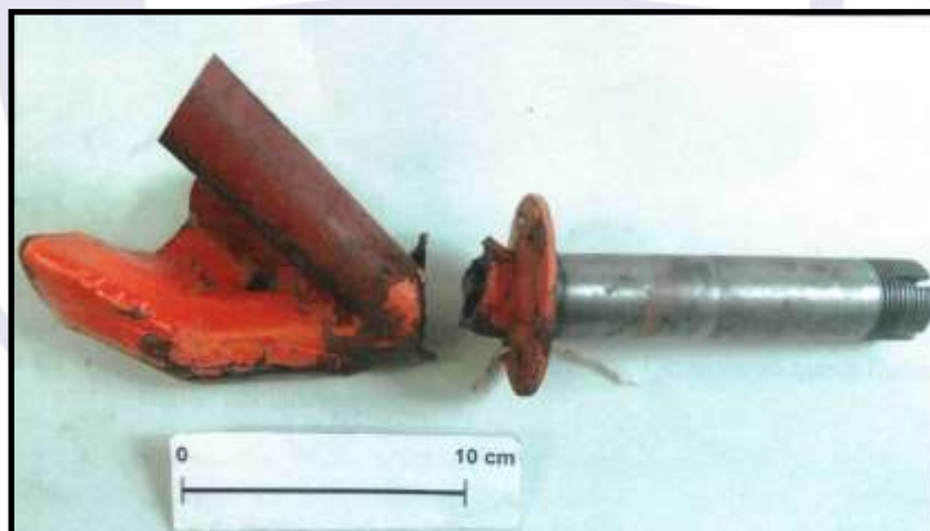
Figura 3 - Componente fraturado do eixo do trem de pouso.
