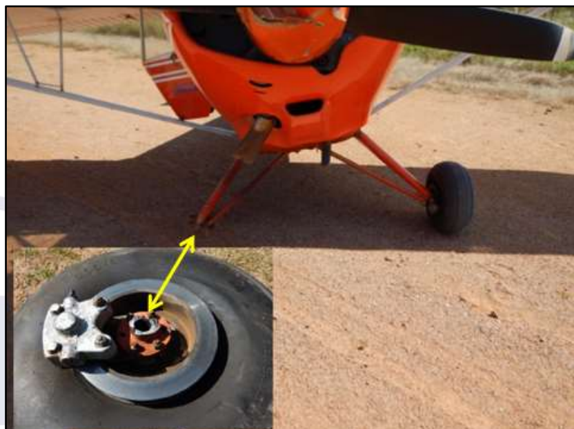
Figura 2 - Danos ao trem de pouso direito. No detalhe, a roda direita com o eixo da perna do trem de pouso quebrado.
